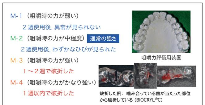
図8 咀嚼力評価用装置による咀嚼力の評価方法と評価基準
